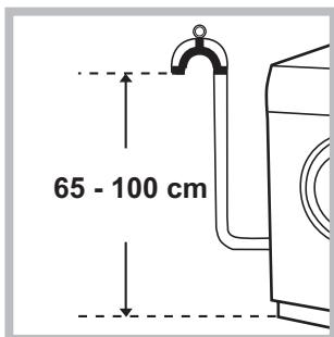
Podłączyć przewód odpływowego, nie zginając go, do rury ściekowej lub do otworu odpływowego w ścianie, które powinny znajdować się na wysokości od 65 do 100 cm od podłogi;
