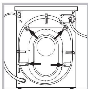
3. Odkręcić 4 śruby zabezpieczające maszynę na czas transportu oraz zdjąć gumowy element z podkładką, znajdujący się w tylnej części pralki (patrz rysunek).
