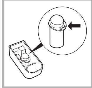
Wstawić dodatkowy pojemniczek 4, na wyposażeniu, do przegródki 1. Przy dozowaniu wybielacza nie przekroczyć poziomu „max” wskazanego na środkowej ośce (patrz rysunek). Aby wykonać tylko wybielanie, należy wlać wybielacz do dodatkowego pojemnika 4 i nastawić
