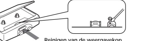
Reinigen van de weergavekop en de bandloop-onderdelen
