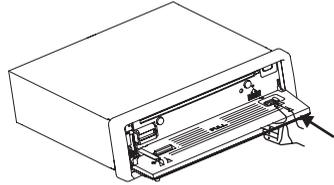
3. PUSH IT TO INSTALL THE FRONT PANEL COMPLETELY .
