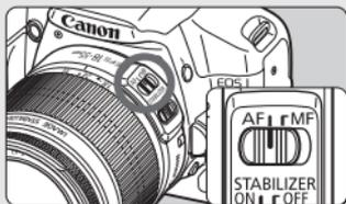
**Set the lens focus mode switch to <AF>.** (p.33)
