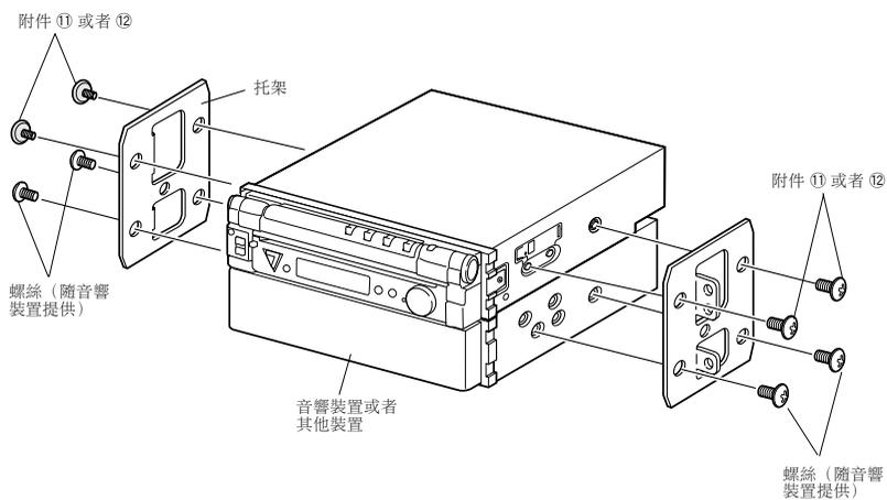
■ 當將汽車托架向使用如下圖所示“●”位置的孔的豐田牌汽車安裝時
