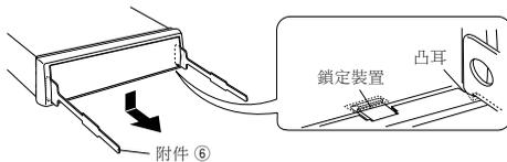
2. 下側拆卸後，上側兩處也以同樣方法拆卸。
