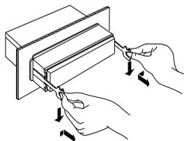
5. 用手托住装置拉出，以免掉落。
