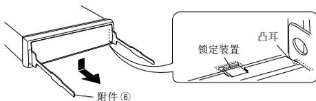
2. 下侧拆卸后，上侧两处也以同样方法拆卸。
