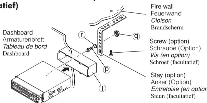
Install the unit at an angle of less than 30°, taking it into account that the monitor would eject when in use (see below). Bauen Sie das Gerät ein einem Winkel von weniger als 30° ein, wobei Sie darauf achten, dass der Monitor bei Gebrauch ausfährt (siehe unten).
