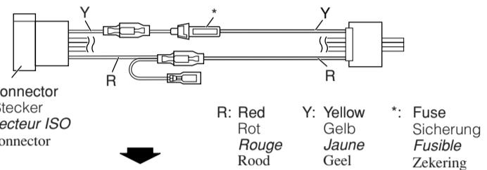
Modified wiring 1 / Geänderte Verdrahtung 1 / Câblage modifié 1 / Aangepaste bedrading 1
