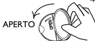
installare la nuova batteria con il lato "+" rivolto verso l'alto
