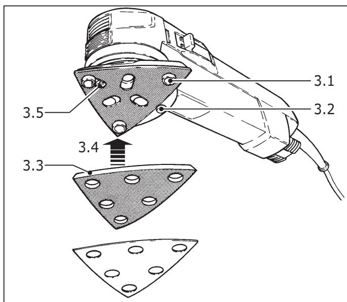
El taco esmerilador consiste de espuma MPE (poliuretano-elastómero microcelular) con cantos inclinados hacia afuera (3.3). En la superficie superior el taco esta provisto de terciopelo y en la superficie inferior con una capa de Stickfix. El taco se pone con el lado de terciopelo sobre la capa de Stickfix de la mesa de esmerilado (3.4). A fin de facilitar el ajuste, la mesa de esmerilado del aparato está provista con tres peraltes de centraje (3.1) en las esquinas.
