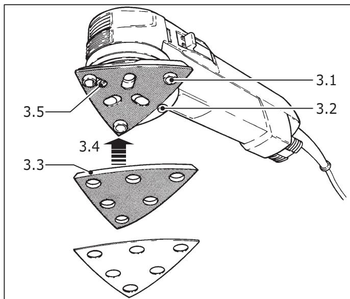
La semelle est en mousse d'élastomère polyuréthane micro cellulaire ses bords sont inclinés vers l'extérieur (3.3). Elle est pourvue, sur la face supérieure, de velours et, sur la face inférieure, d'un revêtement Stickfix. La semelle est pressée côté velours sur le revêtement Stickfix du plateau de ponçage (3.4). Pour obtenir un ajustage aisément, le plateau de ponçage de l'appareil est pourvu de trois élévations de centrage sur ses coins (3.1).
