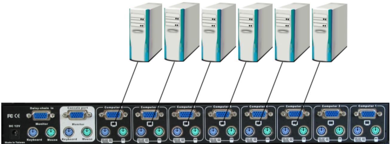
Anschluss der Rechner (Bild zeigt CPU Switch P8 Rückseite)
