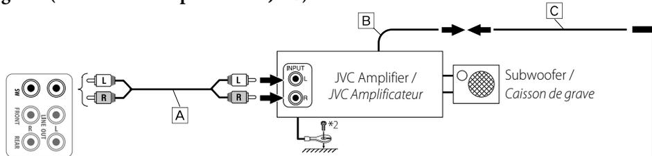
**Connecting the front speakers (through a JVC amplifier) / Connexion des enceintes avant (à travers un amplificateur JVC)**
