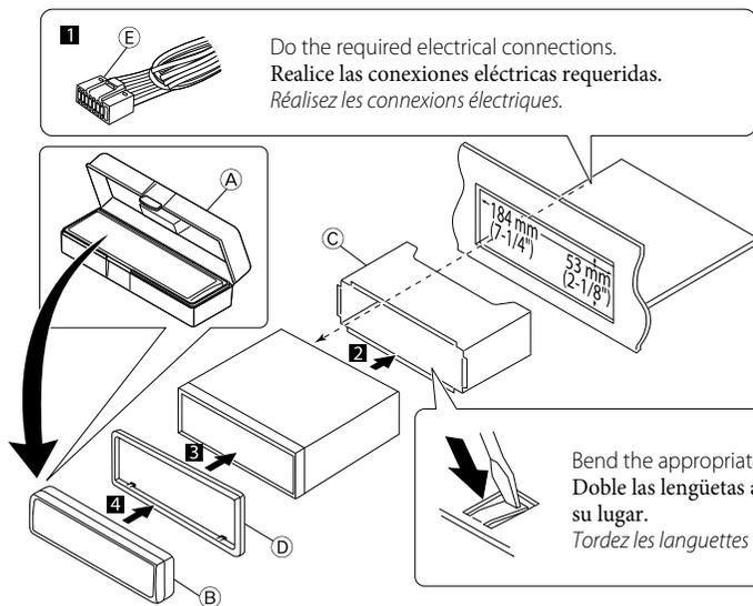
Do the required electrical connections. / Realice las conexiones eléctricas requeridas. / Réalisez les connexions électriques.
