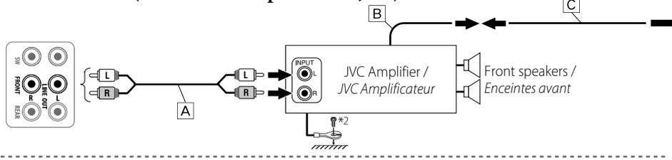
**Connecting the rear speakers (through a JVC amplifier) / Connexion des enceintes arrière (à travers un amplificateur JVC)**
