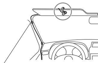
Secure the microphone cord using cord cramps\*<sup>1</sup> if necessary. / Si es necesario, asegure el cable del micrófono por medio de abrazaderas\*<sup>1</sup>. / Fixez si nécessaire le cordon du microphone en utilisant des serre-fils\*<sup>1</sup>.
