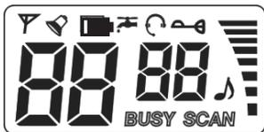
Le FR-540 est doté d'un afficheur à cristaux liquides permettant de visualiser les réglages et les fonctions de l'appareil. Lorsque la radio est allumée, presser une touche quelconque éclaire l'afficheur pendant 5 secondes.
