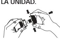
Coloque una batería de 9 voltios dentro del compartimiento, primero del lado de las terminales, haciendo coincidir las terminales (+) y (-) de la batería con las indicadas en el compartimiento.
