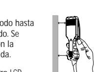
Coloque el StudSensor™ Pro LCD plano contra la pared sin encenderlo.
