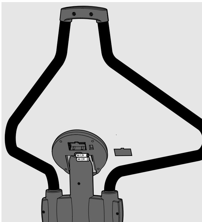
Eine schwache oder erloschene Computeranzeige macht einen Batteriewechsel erforderlich. Der Computer ist mit zwei Batterien ausgestattet. Nehmen Sie den Batteriewechsel wie folgt vor:
