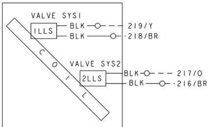
FIGURE 18 - 25 TON LIQUID LINE SOLENOID WIRING
