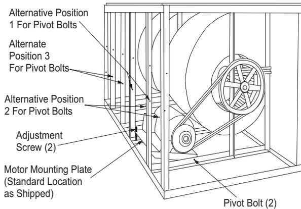
**FIGURE 2 - LB600 FACTORY MOTOR MOUNTING POSITION**
