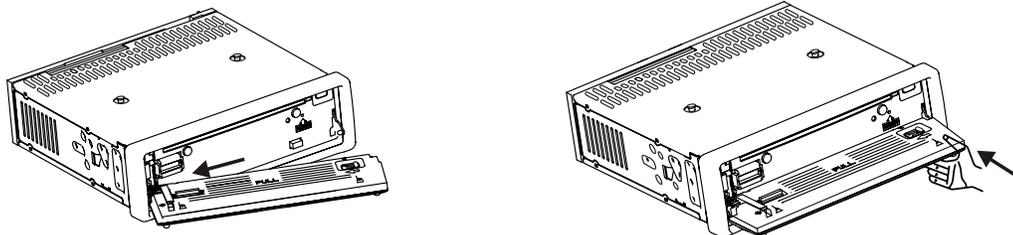
3. PUSH IT TO INSTALL THE FRONT FRONT PANEL COMPLETELY .
