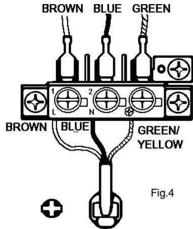
**DO NOT EXTEND THE CABLE USING PLASTIC OR CERAMIC CONNECTION TERMINAL BLOCKS AND/OR INSULATION TAPE.**
