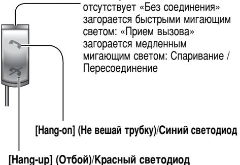
**Контрольная лампа (синий светодиод) состояния**
