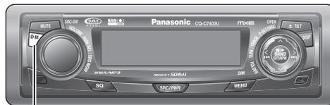
**Remarque:** Si l'appareil est arrêté pendant la réception d'un émetteur par l'intermédiaire de D-M, il reprend la réception de l'émetteur par l'intermédiaire de D-M en le remettant en marche.
