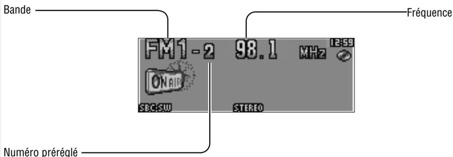
Il est également possible d'assigner votre émetteur favori au bouton **[D-M]**. Le résultat de cette opération a pour effet que votre émetteur favori peut être reçu même lorsque l'appareil est réglé en mode CD ou sur d'autres modes. (Réglage par défaut: FM 87,9 MHz)
