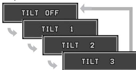
**Remarque:** Le dernier angle sélectionné est maintenu même après la mise hors tension.
