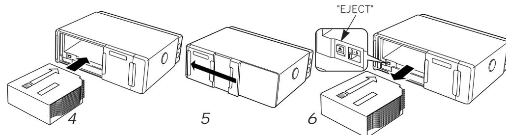
1. Asegúrese de que el cartucho de discos esté debidamente orientado hacia arriba, con el logotipo "disc" hacia arriba. Extraiga la bandeja por medio del saliente.
