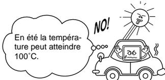
Lorsque l'afficheur à cristaux liquides atteint des températures, hautes ou basses, excessives, les cristaux liquides peuvent devenir le siège de transformations chimiques qui en altèrent le bon fonctionnement.
