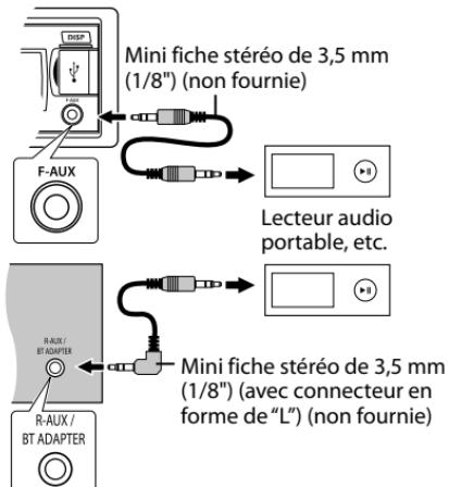
1 Connectez sur F-AUX sur le panneau de commande et/ou sur R-AUX sur le panneau arrière.
