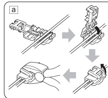
**D Connecting the microphone / Conexión de la unidad de micrófono / Connexion du microphone**
