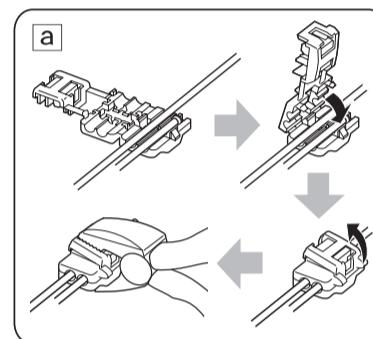
**C Connecting the speed signal lead / Conexión del conductor de señal de velocidad / Connexion du fil de signal de vitesse**
