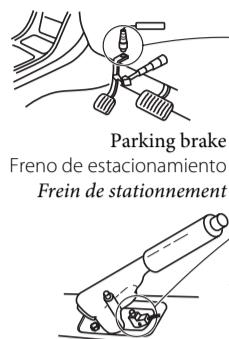
**Conexión del cable del freno de estacionamiento**
