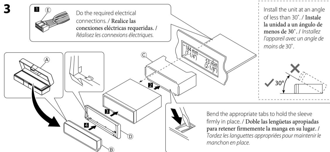
When installing the unit without using the sleeve / Instalación de la unidad sin utilizar la cubierta / Lors de l'installation de l'appareil sans utiliser de manchon
