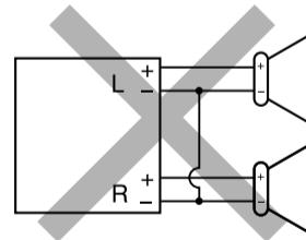
**PRECAUCIONES sobre las conexiones de la fuente de alimentación y de los altavoces**
