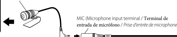
MIC (Microphone input terminal / Terminal de entrada de micrófono / Prise d'entrée de microphone)
