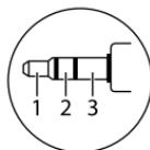
Il est recommandé d'utiliser une mini fiche stéréo munie d'une fiche à 3 connecteurs pour obtenir une sortie audio optimum.
