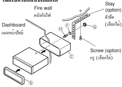
Install the unit at an angle of less than 30°. ติดตั้งชุดประกอบที่มุมต่ำกว่า 30 องศา
