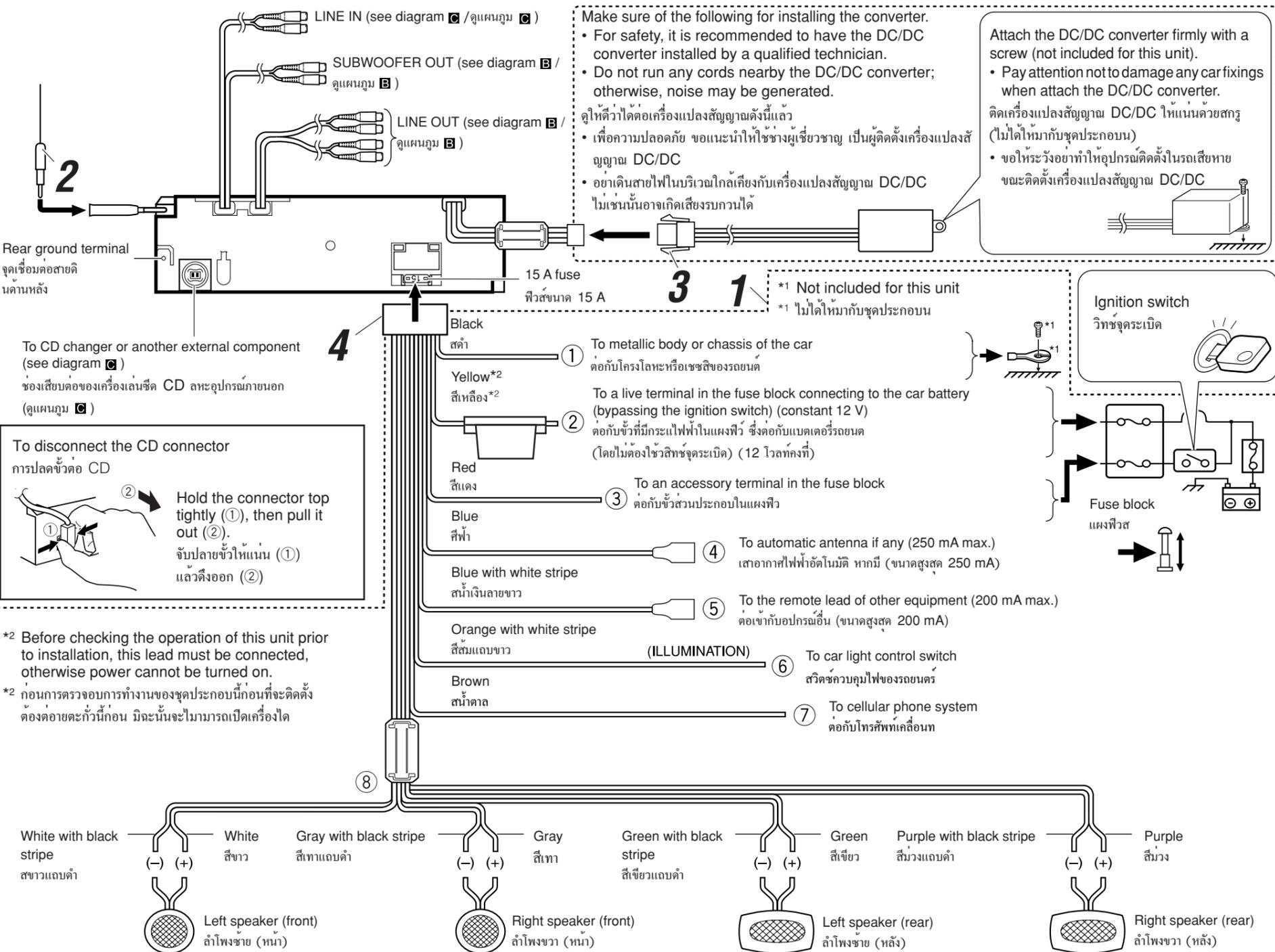
**B Connecting the external amplifiers / การต่อเพิ่มเติมเข้ากับอุปกรณ์อื่น**
