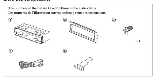
The release key (5) is used for dismounting the unit. See the Operating Instructions manual for details. La clé de dégagement (5) est nécessaire pour démonter l'appareil. Consulter le mode d'emploi pour plus de détails.
