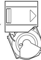
L'encoche du plateau étant face à vous, introduisez l'angle droit du plateau dans la fente et poussez ensuite sur l'angle gauche jusqu'à ce qu'il s'encliquette.
