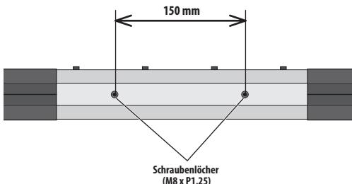
2 Verwenden Sie zwei Schrauben mit Unterlegscheiben, um den Ständer bzw. die Halterung usw. am Lautsprecher zu befestigen.
