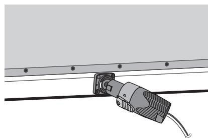
**b Dopo aver inserito completamente il connettore, ruotarlo in senso orario per bloccarlo in posizione.**
