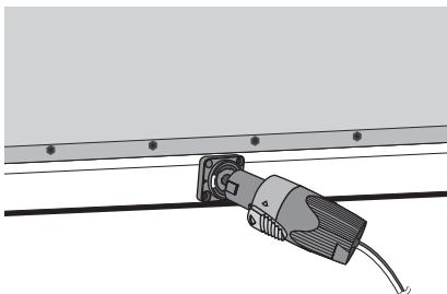
**b Schieben Sie den Steckverbinder bis zum Anschlag in die Buchse, und drehen Sie ihn dann im Uhrzeigersinn, um ihn zu arretieren.**
