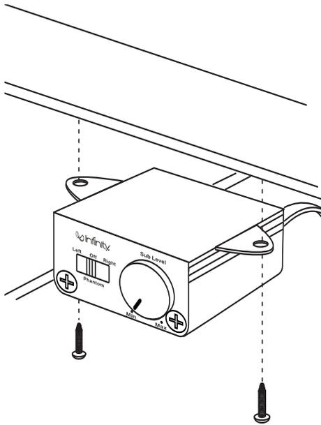
**CONNECTING THE REMOTE LEVEL CONTROL TO BASSLINK II**
