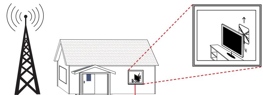
■ Aparatos electrónicos podrían reflejar la señal de la torre de transmisión. Si esto pasa, trate de montar la antena más alto en la pared y escanee de nuevo los canales. Entre más alto este la antena, mejor es la señal que recibirá.
