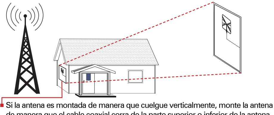
■ Si la antena es montada de manera que cuelgue verticalmente, monte la antena de manera que el cable coaxial corra de la parte superior o inferior de la antena.
