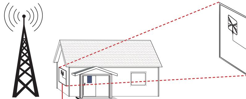
■ Monte la antena en una ventana que mira a la torre de transmisión de las estaciones que desea recibir. Los lados de la antena no puede "ver" la señal bastante desde la torre de transmisión si los lados de la antena miran a la torre.
