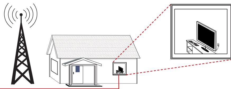
■ Si la antena es montada de manera que quede plana (por ej., sobre una mesa), el cable coaxial deberá apuntar hacia la torre de la señal.
