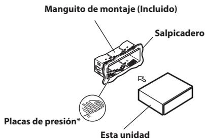
\* Si el manguito de montaje instalado en el salpicadero está flojo, las placas de presión pueden doblarse un poco para solventar el problema.
