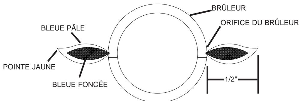
Si le brûleur ne reçoit pas assez d'air, les flammes seront jaunes pâles et produiront possiblement de la suie. Si le brûleur reçoit trop d'air, les flammes scintilleront de façon erratique et causeront possiblement des problèmes d'allumage.
