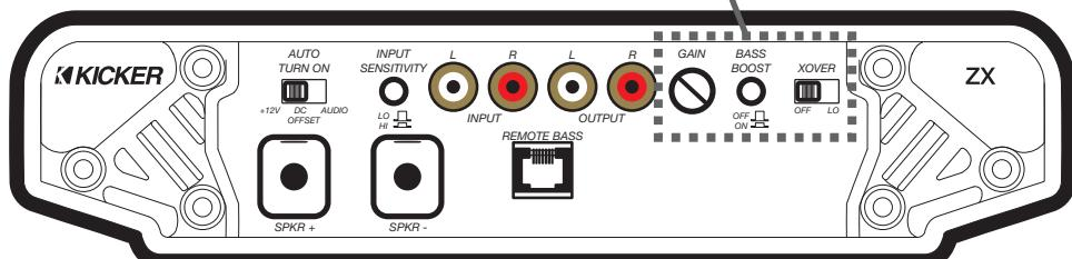
**Sélection de Mise sous Tension Automatique :** La série ZX est dotée de trois modes différents de mise sous tension automatique pouvant être sélectionnés au panneau d'extrémité de l'amplificateur : +12V, DC Offset (décalage c.c.) et Audio. L'utilisation du mode DC Offset ou Audio permet à la borne REM d'avoir une sortie de +12 V pour des amplificateurs supplémentaires.
