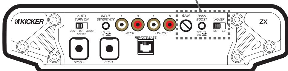
**Automatische Einschaltung:** Die ZX-Serie bietet drei verschiedene automatische Einschaltmethoden, die an der Endplatte gewählt werden können: +12V, DC Offset und Audio. Wenn Sie „DC Offset“ oder „Audio“ verwenden, wird am REM-Terminal +12V für das Einschalten weiterer Verstärker bereit gestellt.
