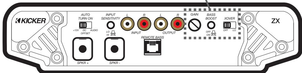
**Selección de Encendido Automático:** La serie ZX ofrece tres modalidades de encendido automático que se pueden seleccionar en el panel de extremo: +12V, compensación de CC y audio. Las modalidades de audio o compensación de CC dan +12V a la terminal REM para encender otros amplificadores.
