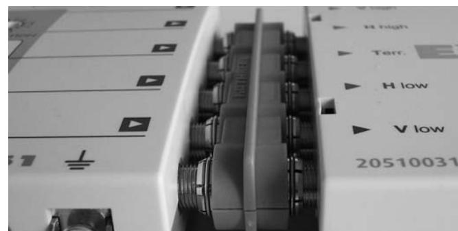
Bei weiter voneinander entfernten Geräten empfiehlt sich die Verwendung von hochwertigen Koaxialkabeln (mit sehr hohen Schirmungswerten) z. B. LCD 111. Verwenden Sie nach Möglichkeit hochwertige F-Stecker (siehe Bild rechts) zum „Crimpen“ oder als Kompressionsstecker (siehe Kathrein-Katalog „Satelliten- und terrestrische Empfangs-Antennenanlagen“).
