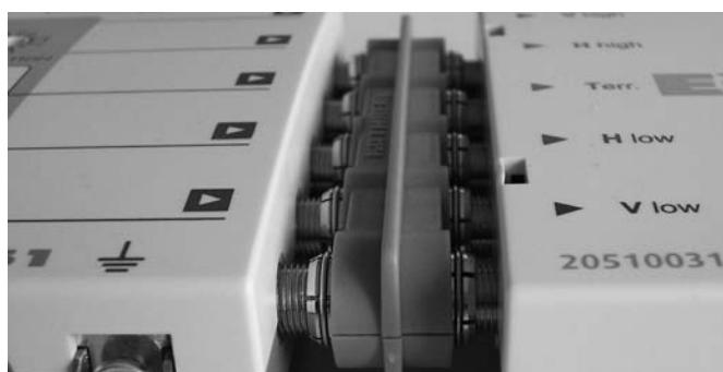
Si les appareils sont éloignés entre-eux, il est conseillé d'utiliser des câbles coaxiaux de qualité (à facteur de blindage très élevé), par ex. du LCD 111. Utilisez si-possible des connecteurs F de qualité (voir la figure de droite) à sertir ou à serrage (voir le catalogue Kathrein « Installations de réception satellite et terrestre »).
