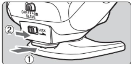
**3 Fixez le 270EX II sur le mini-socle fourni et positionnez le flash.**
