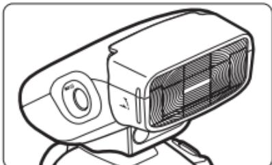
Le nombre guide est de 22 (à 100 ISO en mètres). La couverture maximum du flash correspond à un objectif grand angle EF 28mm (EF-S 18mm).
