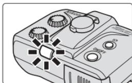
En el modo TTL, cuando el flash SB-R200 se ha disparado a su intensidad máxima y ha podido haber una subexposición, el indicador rojo de flash listo del SB-R200 parpadeará durante 3 segundos. (Los indicadores de flash listo que se encuentran en el SU-800 y en el visor de la cámara no parpadearán).
