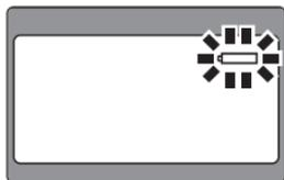
El indicador de batería baja parpadea cuando la luz de flash listo del Controlador del SU-800 no se enciende a los 30 segundos de encender o disparar el flash.
