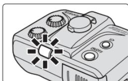
En el modo TTL, cuando el flash se ha disparado a su intensidad máxima y ha podido haber una subexposición, el indicador rojo de flash listo de la unidad parpadeará durante 3 segundos. (El indicador de flash listo que se encuentra en el SU-800 o en el visor de la cámara no parpadea). Para compensar, acérquese al sujeto, utilice una sensibilidad ISO más alta o un diafragma mayor y vuelva a tomar la fotografía.
