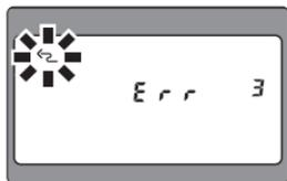
El SU-800 no puede utilizarse con cámaras de la serie COOLPIX diferentes de COOLPIX P6000. Si se utiliza, el indicador flash inalámbrico parpadea a modo de advertencia.
