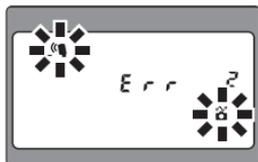
Si el SU-800 está montado en una cámara no compatible con CLS, la función Controlador no se activa. Aparecen unos indicadores de advertencia si se ajusta el modo Controlador.
