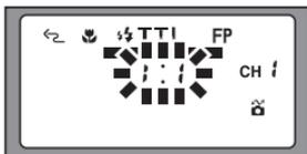
Indican que estos elementos se pueden ajustar o modificar. Se detiene después de parpadear seis veces, a no ser que se realice un ajuste.
