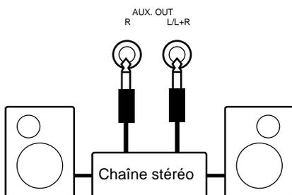
Les prises AUX. OUT R et L/L+R permettent de transmettre le son du Clavinova à un amplificateur d'instrument, une table de mixage, un amplificateur de puissance, ou un appareil d'enregistrement. Lorsque le Clavinova doit être connecté à un système de sonorisation mono, n'utilisez que la prise L/L+R. Lorsque la prise L/L+R est utilisée seule, les signaux du canal droit et du canal gauche sont combinés et sortent par la prise L/L+R de sorte que vous ne perdez rien du son du Clavinova.
