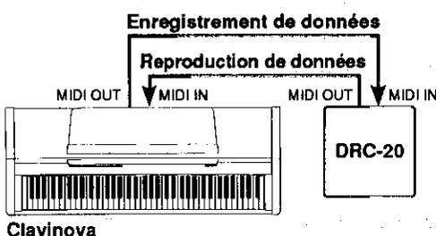
Le même type de transfert de données musicales est utilisé pour effectuer un enregistrement de séquence MIDI. Un enregistreur de séquence, comme par exemple l'enregistreur à disque DRC-20, peut être utilisé pour "enregistrer" les données MIDI transmises par le Clavinova. Lorsque les données enregistrées sont reproduites, le Clavinova joue automatiquement la séquence enregistrée dans ses moindres détails.
