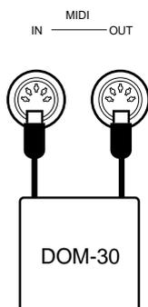
Le connecteur MIDI IN reçoit les données MIDI transmises par un appareil MIDI externe (comme par exemple l'enregistreur à disque DRC-20 ou le module Disk Orchestra DOM-30) qui peuvent être utilisées pour commander le Clavinova. Le connecteur MIDI OUT transmet les données MIDI générées par le Clavinova (par exemple, les données de note et de dynamique générées au clavier du Clavinova).
