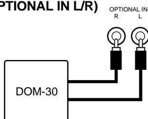
Ces prises ont été prévues essentiellement pour le raccordement d'un module générateur de sons externe, comme par exemple le module Disk Orchestra DOM-30. Les sorties stéréo du module générateur de sons externe sont connectées aux prises OPTIONAL IN L et R, ce qui permet la reproduction du son du module externe via les haut-parleurs et le système de sonorisation interne du Clavinova.
