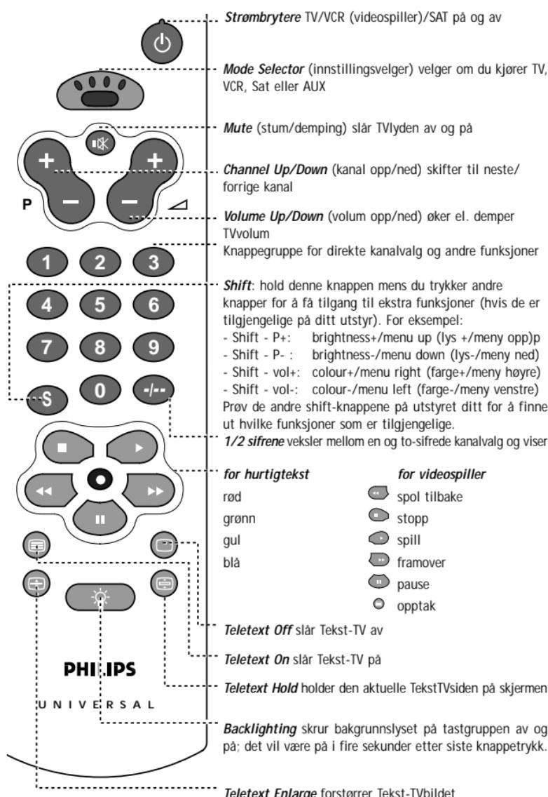
**Prøv deg fram!** Den letteste måten å finne ut hvordan fjernkontrollen virker, er å prøve å trykke på knappene for å se hva som skjer – ikke vær redd, du kan ikke ødelegge noe! De fleste knappene virker på samme måte som på den opprinnelige fjernkontrollen din. Om du trykker på en knapp for en spesiell funksjon har den selvsagt ingen virkning hvis ikke din TV eller videospiller har denne funksjonen.
