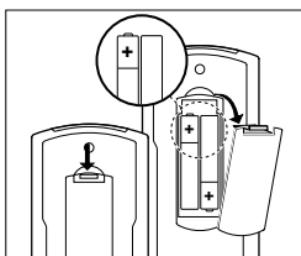
Du trenger to 1.5V batterier, bare type R03, UM4 eller AAA. Sett dem i slik:
