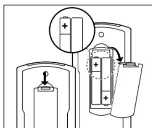
U heeft twee 1,5 V-batterijen nodig , type R03, UM4 of AAA. Plaats de batterijen als volgt.
