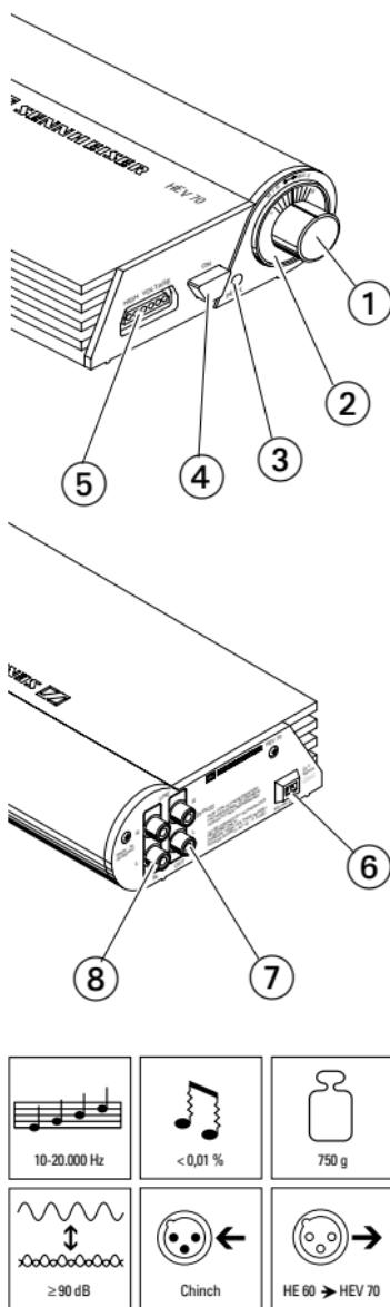
De versterker HEV 70 werd speciaal voor het functioneren van de elektrostatische koptelefoon HE 60 ontwikkeld. Als hogevolts-/halfgeleiderversterker levert hij enerzijds de benodigde polarisatie spanning voor de elektrostatische koptelefoon HE 60 en versterkt hij anderzijds het binnenvkomende geluidssignaal.
