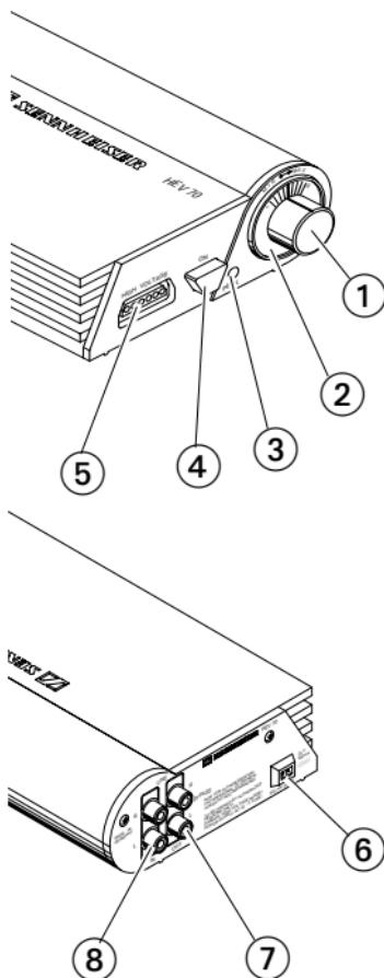
Speziell für den Betrieb des elektrostatischen Kopfhörers HE 60 wurde der Verstärker HEV 70 entwickelt. Als Hochvolt-/Halbleiterverstärker liefert er einerseits die benötigte Polarisationsspannung für den elektrostatischen Kopfhörer HE 60 und verstärkt andererseits das eingehende Tonsignal.
