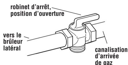
La canalisation d'arrivée de gaz doit être dotée d'un robinet d'arrêt homologué. Ce robinet devrait être au voisinage du brûleur latéral, à un endroit où on peut y accéder facilement pour les manœuvres d'ouverture et de fermeture. Ne pas entraver l'accès au robinet d'arrêt. Le robinet permet d'ouvrir ou de fermer l'alimentation en gaz de l'appareil.
