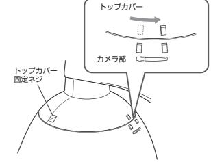
**2.** アーム部からカメラ部をはずす 接続部固定ネジをはずします。 (3個所)
