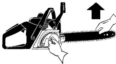
5. Remettre la manette du bouton de réglage dans sa position initiale. Assurez que les dents du bouton de réglage sont engagés dans les entailles dans le frein à chaînes et que la manette est plat.
