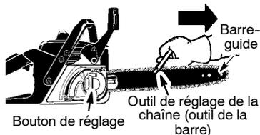
4. Soulever la manette du bouton de réglage et tourner celui-ci d'un tour en sens anti-horaire pour desserrer le barre-guide. La chaîne se tendra automatiquement.
