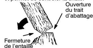
**REMARQUE:** Avant de terminer le trait d'abattage, utilisez des coins pour ouvrir la coupe quand il sera nécessaire de contrôler la direction de la chute. Utilisez des coins en bois ou en plastique, mais jamais des coins en acier ou en fer qui risqueraient d'entraîner un recul ou d'endommager la chaîne.
