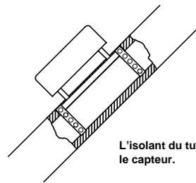
L'isolant du tuyau doit recouvrir l'écran qui contient le capteur.
