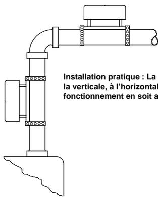
Installation pratique : La commande peut être montée à la verticale, à l'horizontale ou sur un angle sans que son fonctionnement en soit affecté.
