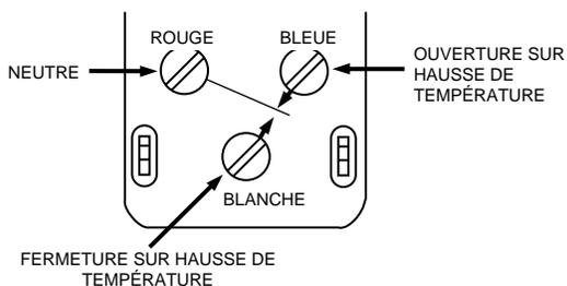
Le régulateur est doté d'un commutateur unipolaire bidirectionnel à déclic. La borne située en haut, à gauche (rouge) est la borne neutre. Celle qui se trouve en haut, à droite (bleue) ouvre le circuit sur une hausse. La borne centrale inférieure (blanche) ferme le circuit sur une hausse.
