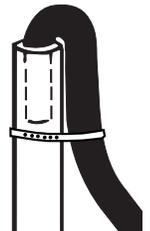
**7.** Avant de connecter les tuyaux d'arrivée d'eau, laisser l'eau couler dans un seau à partir des deux robinets d'alimentation, pour éliminer les particules solides présentes dans les conduites d'arrivée d'eau qui pourraient obstruer les tuyaux. Identifier le robinet d'eau chaude.
