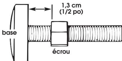
**10.** Utiliser les pieds et les écrous fournis dans le sachet de pièces. Visser l'écrou jusqu'à environ 1,3 cm (1/2 po) de la base.
