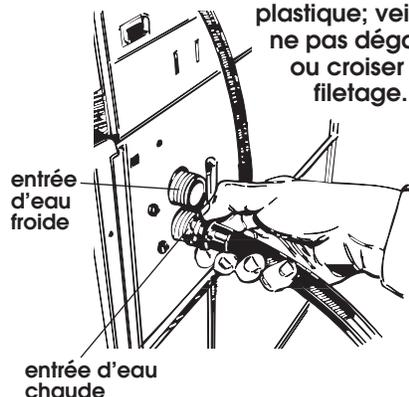
**3.** Connecter d'abord un tuyau d'arrivée d'eau à l'entrée inférieure; connecter ensuite le deuxième tuyau à l'entrée supérieure. Serrer les raccords à la main; utiliser ensuite une pince pour serrer les raccords de deux tiers de tour de plus.
