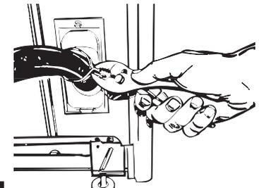
**5.** Placer la bride pour tuyau sur le raccord d'évacuation de la laveuse. Pousser le tuyau d'évacuation sur le raccord de la laveuse. Utiliser une pince pour ouvrir la bride et la glisser sur le tuyau d'évacuation. S'assurer qu'elle est bien serrée.
