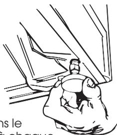
**11.** Insérer le pied dans le trou convenable à chaque angle avant de la laveuse, jusqu'à ce que l'écrou soit en contact avec la base de la laveuse. **Ne pas** serrer les écrous avant l'étape 14.
