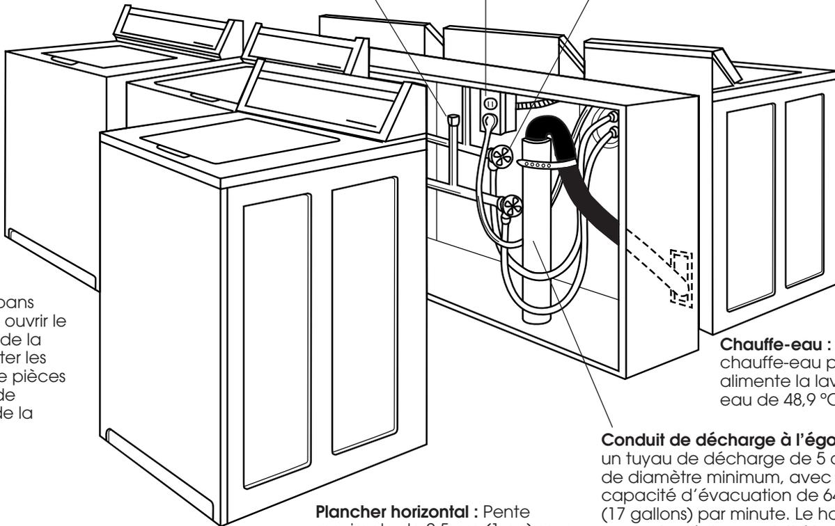
**Chauffe-eau :** Régler le chauffe-eau pour qu'il alimente la laveuse en eau de 48,9 °C (120 °F).
