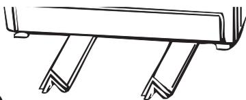
**9.** Mettre deux cornières l'une par-dessus l'autre. Incliner la laveuse vers l'arrière et insérer les cornières à 7,6 cm (3 po) de chaque côté de la laveuse.
