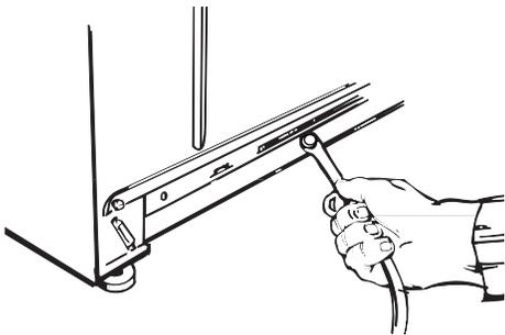
Tirer fermement pour séparer l'extrémité de la sangle de l'arrière de la laveuse. Pour la libération des pieds arrière qui assurent la mise à niveau de la laveuse, il faut que le bouton de la sangle soit totalement retiré de la laveuse.
