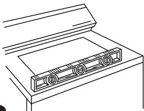
**13.** Incliner la laveuse vers l'avant pour soulever les pieds arrière de 2,5 cm (1 po) au-dessus du plancher. Laisser la laveuse redescendre doucement jusqu'au plancher. Vérifier l'aplomb de la laveuse transversalement et de l'avant à l'arrière (des deux côtés) avec un niveau.
