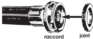
**2.** Insérer un joint dans chaque raccord des tuyaux d'arrivée d'eau. Vérifier que les joints sont bien placés au fond des raccords.
