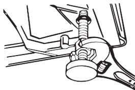
**14.** Si la laveuse n'est pas d'aplomb, visser les pieds avant vers le haut ou vers le bas pour réaliser l'aplomb. Exécuter le contrôle final avec un niveau.
