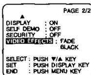
**2** Press **DISPLAY** for VIDEO EFFECTS menu. Press **DOWN ▼** to select **DIGITAL FADE**.
