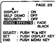
**2** Press **DISPLAY** for VIDEO EFFECTS menu. Press **DOWN ▼** to select **DIGITAL FADE**.
