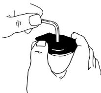
Desserrer la vis comme indiqué. Régler en fonction de la direction d'échappement souhaitée, puis resserrer la vis.
