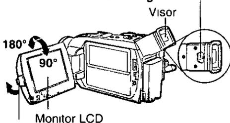
**3** Presione el botón de apertura del LCD (LCD-OPEN) para desbloquear el monitor LCD. Balancee abriéndolo completamente y ajuste el ángulo
