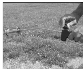
Figura 5 - Giro de la válvula de gas (a la derecha para cerrar, a la izquierda para abrir) (WT4500 se muestra, WT5500 similar)
