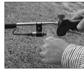
Figura 6b - Uso de un encendedor piezométrico
