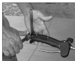
Figura 2 - Conexión de la línea de gas al mango (WT4500 se muestra, WT5500 similar)
