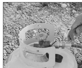
Figura 4 - Ajuste de la conexión del cilindro usando una llave
