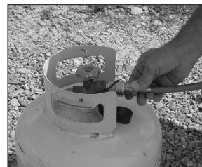
Figura 3 - Ajuste manual de la conexión del cilindro
