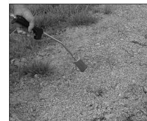
Figura 7 - Accionamiento del gatillo para inyección turbo de la llama (WT4500 se muestra, WT5500 similar)
