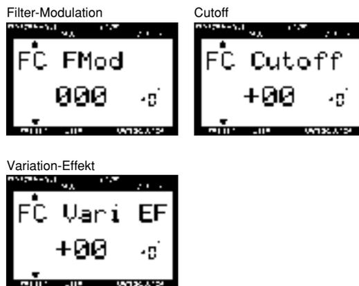
**FMOD (Filter-Modulation):** Mit diesem Parameter stellen Sie die Tiefpassfilter-Modulationstiefe ein, die durch den LFO (Niederfrequenz-Schwingkreis) erzeugt wird. Der hier eingestellte Wert bestimmt den Bereich der Filter-Modulation, den Sie mit dem Foot Controller beeinflussen können. Wenn Sie den Foot Controller drücken, erhöht dies die Tiefe der Filter-Modulation.
