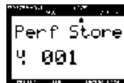
Beim Speichern einer Performance wird auch die Position aller SOUND CONTROL-Knöpfe gespeichert. Wenn Sie daher die gespeicherte User Performance im Performance Play-Modus wieder abrufen, erzeugt der CS2x einen Klang, der den Einstellungen der SOUND CONTROL-Knöpfe zum Zeitpunkt der Speicherung entspricht. (Eine Drehung des Knopfes stellt den Klang mit den gegenwärtigen Positionen der SOUND CONTROL-Knöpfe wieder her.)
