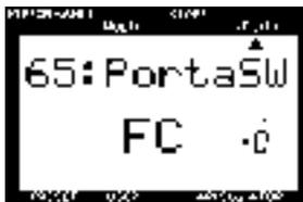
5. Verwenden Sie den ASSIGN CTRL NO [UP/DOWN]-Schalter, um die Steuerungswechsel-Nummer und Bezeichnung des Parameters zu wählen, den Sie steuern möchten.
