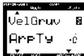
Auf der LCD-Anzeige erscheint eine umgekehrter Buchstabe "S" neben der TYPE-Bezeichnung, um anzuzeigen, dass die ARPEGGIATOR SPLIT-Funktion eingeschaltet ist. Um sie wieder auszuschalten, halten Sie [SHIFT] gedrückt und drücken Sie [DOWN].
